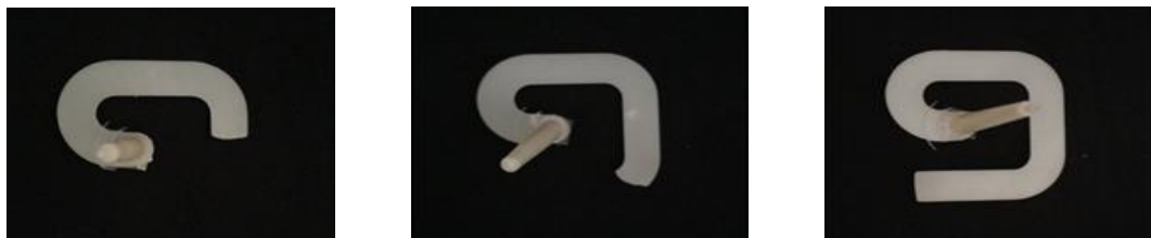
Hình 3.15: Một số kết quả thực nghiệm chiều dài dòng chảy lòng khuôn xoắn ốc
